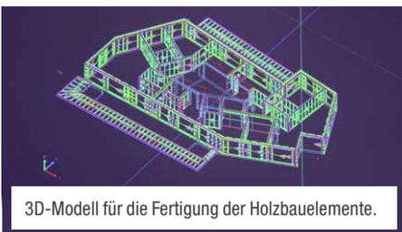
Die Produktion erfolgt zum einen automatisiert und es kommen Nagel- oder Bohrboter sowie CNC-Maschinen zum Einsatz. Zum anderen wird von Hand gearbeitet.
